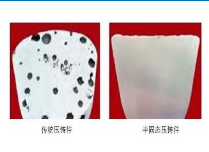
图 21：半固态压铸件组织更致密，传热性能好
